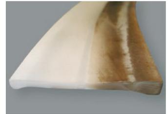
Querschnitt eines GORE® Dichtungsbands Serie 1000 nach Einsatz unter schwierigen Prozessbedingungen
