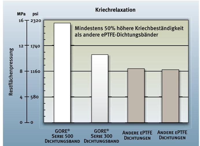
Kriechrelaxation, basierend auf EN13555,  $P_{QR}$  unter Verwendung von 15mm x 3mm Bändern, gelegt zu einem geschlossenen Ring ( $\varnothing 150$ mm).  $P_{QR}$ -Werte wurden bei 30MPa und 150°C ermittelt.
