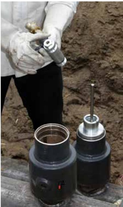
Vor der Montage sind die Dichtungen auf Ihren Zustand zu überprüfen und gegebenenfalls zu erneuern. Verschleißteile, wie Lochsägen und Zentrierbohrer werden überprüft und bei Verschleiß ersetzt.
